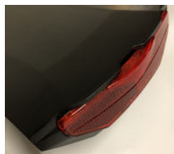
Baglygten er integreret i batteriet
