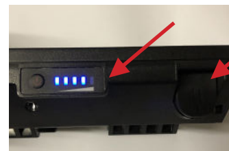
Dioder viser ladetilstand/kapacitet. Opladningsport ses yderst til højre
