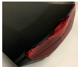
Baglygten er integreret i batteriet
